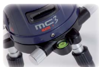
Libelle und Feinjustierschrauben für Rotationsplattform
